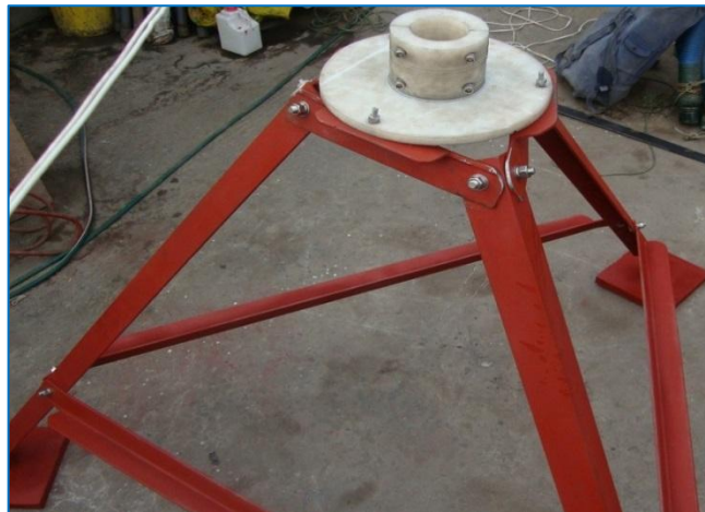
Figura 42: Trípode para el fondeo de equipos Correntómetro Doppler y Ológrafo Direccional
